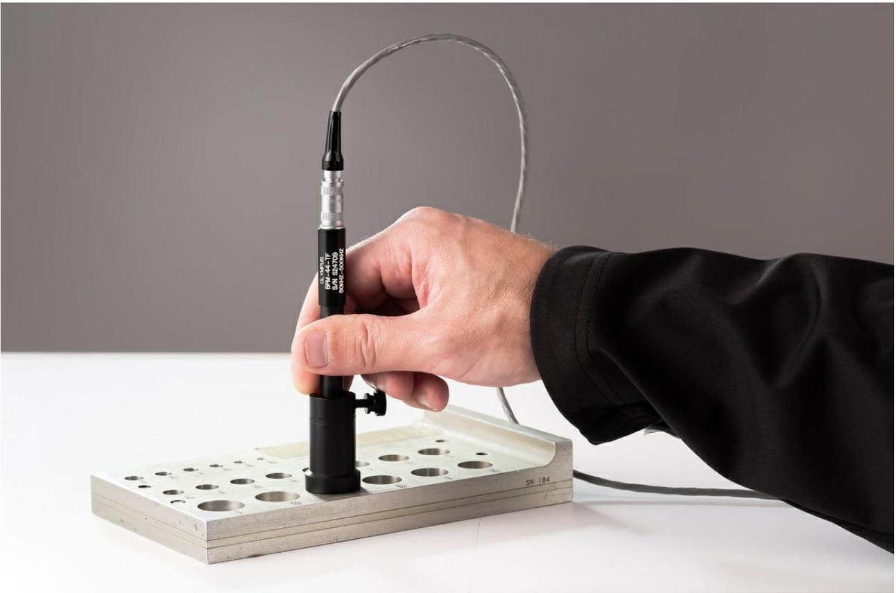
Figure 4 – Sonde manuelle et câble standard, montrant la torsion typique du câble lors de l'inspection manuelle des trous de boulons ou de fixations
